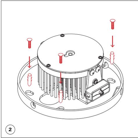
fissaggio a modulo di sostegno
