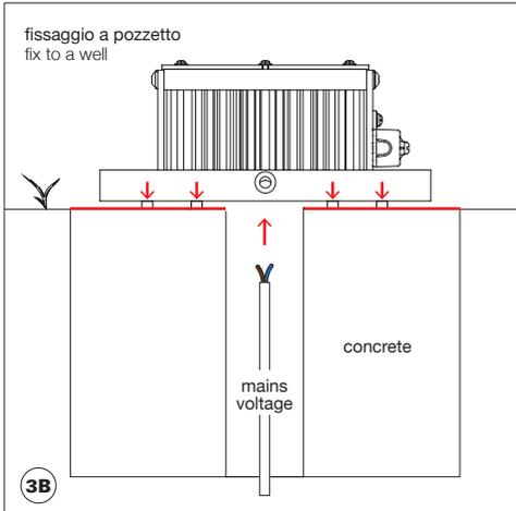
fissaggio a basamento in cemento
