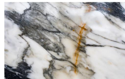
impurità ferrose (dettaglio) - ferrous impurities (detail)
