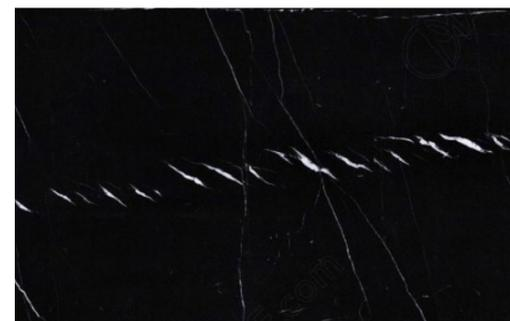
linee di screpolatura (dettaglio) - cracking lines (detail)
