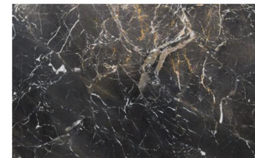
impurità ferrose (dettaglio) - ferrous impurities (detail)
